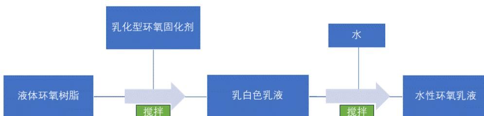
I 型水性环氧体系中, 水性环氧固化剂不仅在涂膜中与环氧树脂交联反应, 而且在液相中作为环氧树脂的乳化剂。A, B 组分混合搅拌均匀后, 乳液颗粒立即包含固化剂和环氧树脂。高浓度环氧基和固化剂活泼氢在同一分散粒子内近距离接触, 导致粒子内的交联反应速度快。因此, 该类系统的适用期通常较短, 通常为 20 分钟至 2 小时。
