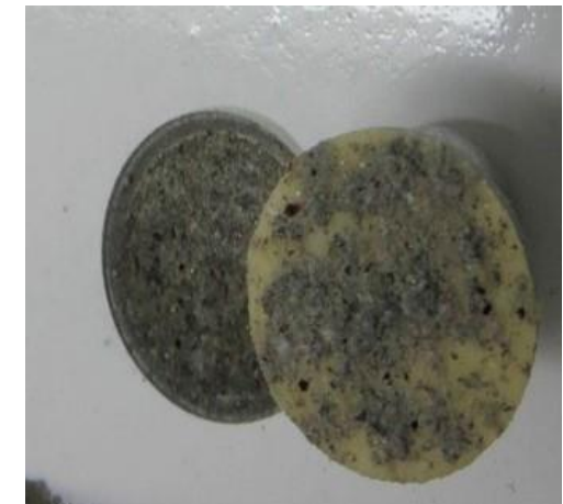
湿混凝土 拉拔检测:4.25MPa 11
