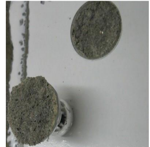
干混凝土 拉拔检测:6.33MPa
